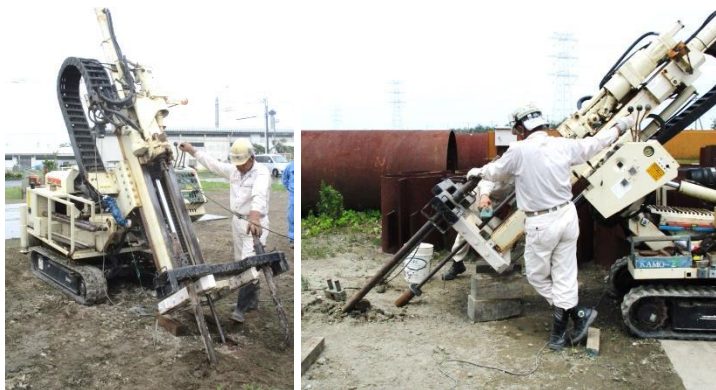
写真-2 CPTU の斜め下方貫入の一例
